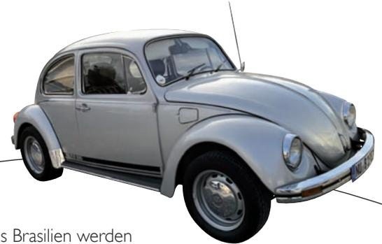
Die Fahrzeuge aus Brasilien werden von uns **natürlich auf EU-Standard umgerüstet**. Von den Stoßfängern bis zur Beleuchtung. Bei den Akkus verlassen wir uns auf Tesla-Technik. Die 5,3-kWh-Module werden hinter der Rückbank oder anstelle des Tanks montiert.
